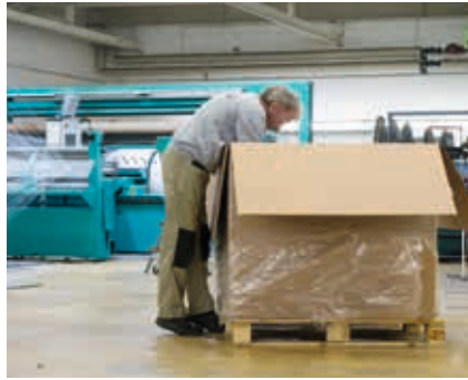
Zwei Beispiele von vielen: Das Herausnehmen von Spulen aus Palettenkartons war vor allem bei den unteren Lagen ergonomisch ungünstig. Ein Palettenheber mit Kippfunktion schaffte Abhilfe.
