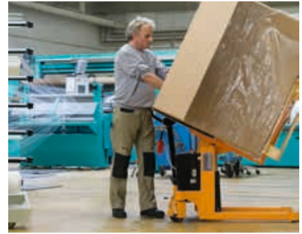
Zwei Beispiele von vielen: Das Herausnehmen von Spulen aus Palettenkartons war vor allem bei den unteren Lagen ergonomisch ungünstig. Ein Palettenheber mit Kippfunktion schaffte Abhilfe.
