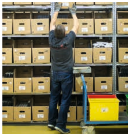
Im Versand erleichtert nun ein Federbodenwagen mit Tritt die Entnahme der Ware aus den oberen Regalreihen. Der Federboden reduziert die Belastung beim Befüllen der Transportbehälter.
